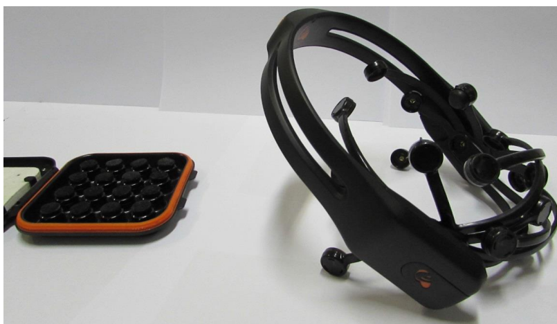
Figura 4 – Emotiv EPOC (à direita) e o estojo de armazenamento e hidratação dos discos de feltro.
