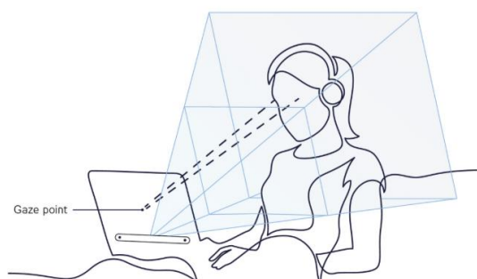
Figura 9 – Desenho esquemático do funcionamento de um dispositivo de IROG.
