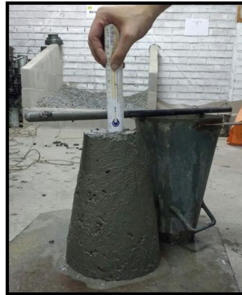
Figura 22 - Ensaio de abatimento do concreto
