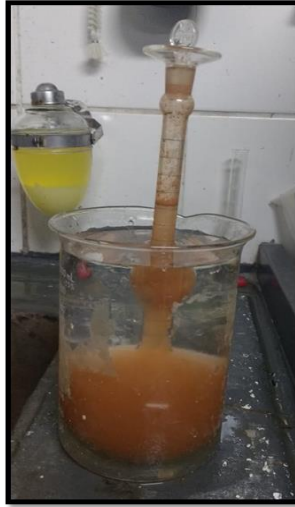
Figura 18 - Massa específica com o frasco de Le Chatelier.
