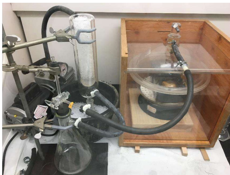
Figura 3 – Aparato utilizado para o tratamento das amostras sob vácuo.
