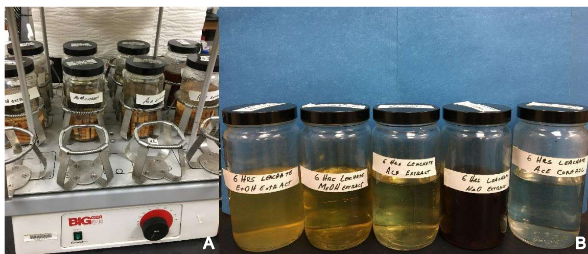
Figura 4 – Frascos utilizados no ensaio de lixiviação sob agitação constante em agitador mecânico (A) e líquidos coletados após os períodos predeterminados (B).
