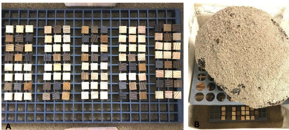
Figura 9 – Montagem e distribuição das amostras (A); disposição da colônia de térmita para o ensaio de preferência alimentar (B).
