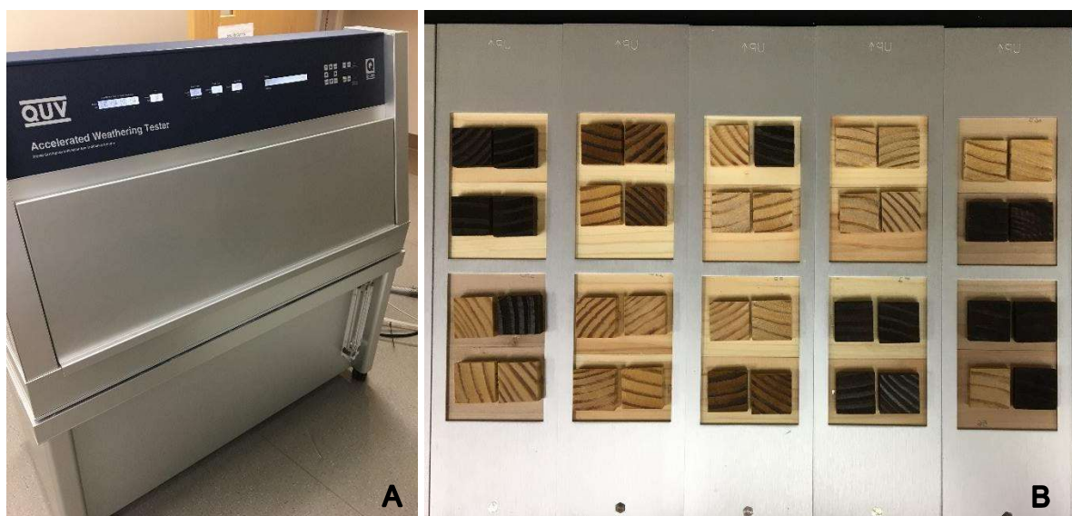
Figura 5 – Camara de intemperismo acelerado utilizadas (A) e amostras tratadas dispostas nas janelas de exposição (B).
