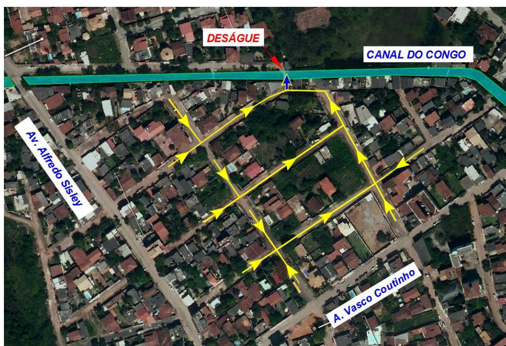
Figura 16: Ponto de deságue da rede de drenagem
