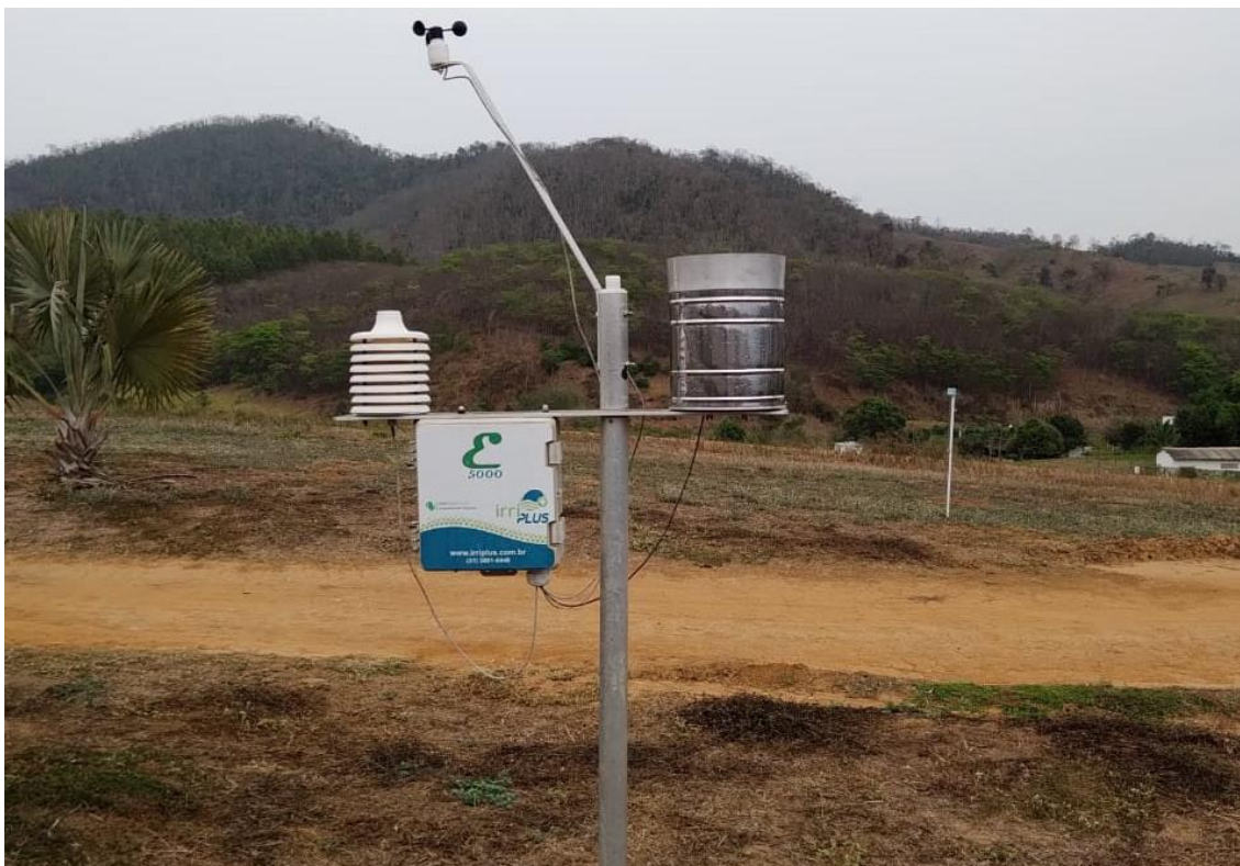
Figura 4. Estação meteorológica automática local (EMAL), modelo E5000 da IRRIPPLUS, instalada na área de café conilon onde o experimento foi conduzido.
