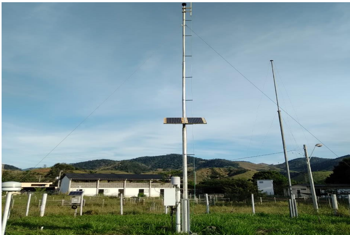
Figura 5. Estação meteorológica automática do Inmet (EMAI), localizada na Área Experimental do Centro de Ciências Agrárias e Engenharias da Universidade Federal do Espírito Santo (CCAUEFES).
