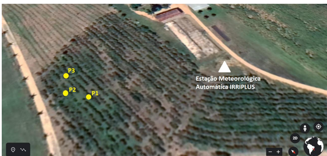
Figura 1. Área experimental com a localização da Estação Meteorológica Automática IRRIPLUS e dos Pontos P1, P2 e P3 de coleta de dados.
