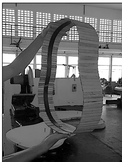
Fotos 35 e 36 – Lateral da caixa acústica do violão de bambu Conclusão da montagem na matriz/molde(esquerda) e desmoldada (direita); Fonte: O autor
