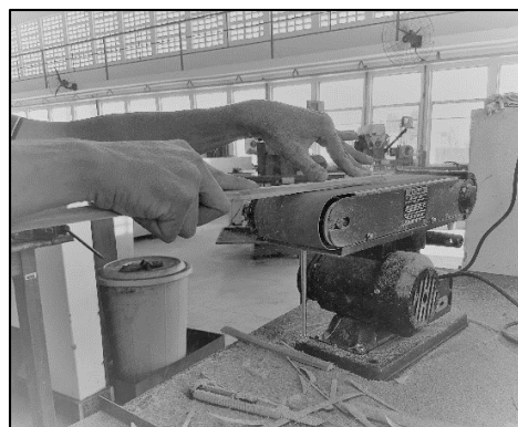
OPIM – Atividades, equipamento e instrumentos Impressão com caneta 3D (esq.); Lixamento de taliscas de bambu (dir.) Fonte: O autor
