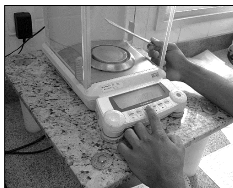
Fotos 28 e 29 – Ensaio mecânico (destrutível) de tração: corpos de prova de ABS Procedimentos preliminares: conferência dimensional (esquerda) e pesagem (direita) Fonte: O autor
