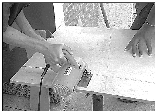
Fotos 39 e 40 – Preparo das peças laterais do cajon Traçagem inicial (esquerda) e recorte (direita) Fonte: O autor
