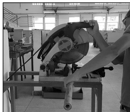
OPIM – Atividades, equipamento e instrumentos Preparo dos 'corpos de prova': Desbaste (esq.); Confeção de peças de bambu: Corte (dir.) Fonte: O autor
