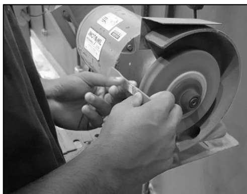
OPIM – Atividades, equipamento e instrumentos Preparo dos 'corpos de prova': Desbaste (esq.); Confeção de peças de bambu: Corte (dir.) Fonte: O autor
