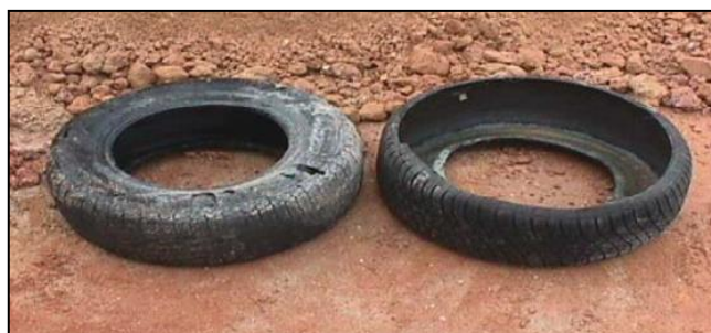
Figura 7: Configuração do pneu: inteiro e com uma parede lateral cortada.
