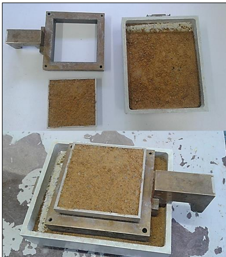
Figura 21: Preparação de amostras para ensaio de cisalhamento.
