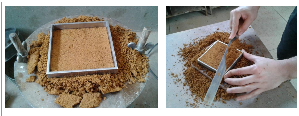
Figura 32: Preparação de amostra de solo puro após compactação.
