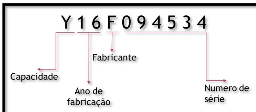
Figura 09 – Nomenclatura dos Hidrômetros
