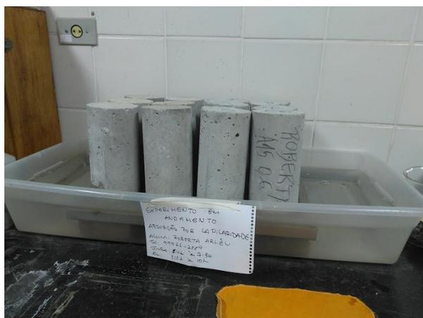
Figura 57 - Pesagem dos corpos de prova
