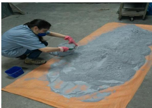
No quarteamento, foi separada uma amostra representativa do resíduo para realização dos ensaios de caracterização, e para a produção dos concretos.
