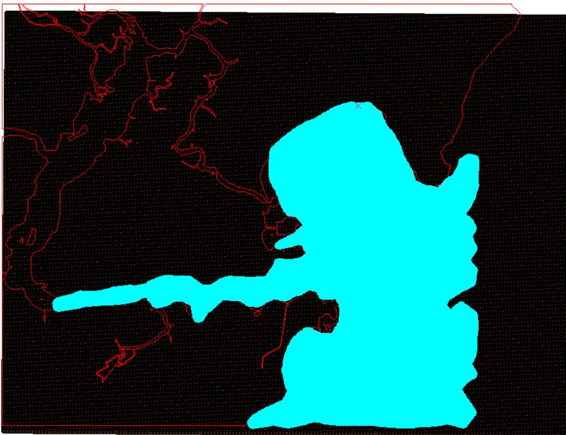
Em relação às linhas de costa, foi realizado um processo semelhante. As linhas de costa reconstituídas (para os anos de 1861, 1928, 1961 e 1978) foram inseridas ao modelo digital de terreno, com cota zero, eliminando-se pontos próximos com cota positiva (até uma distância de 15 metros em direção ao mar) com o objetivo de gerar uma interpolação suave e evitar discrepâncias associadas a precisão. A Figura 33 apresenta em detalhe de escala a seleção de pontos próximos à costa de 1978.
