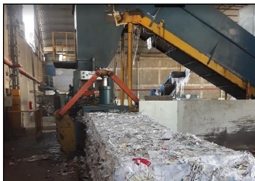
Fotografia 39 - Enfardadeira mecanizada, Aparas Vitória
