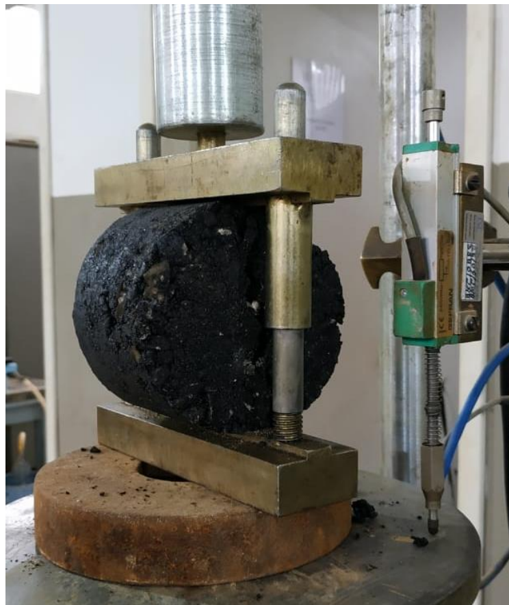
Figura 40 – Ensaio de Determinação de resistência a tração por compressão diametral de CP com adição de 25% de escória.
