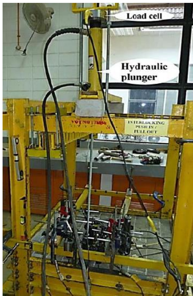
Figura 10 – Equipamento para o ensaio pull-out .
