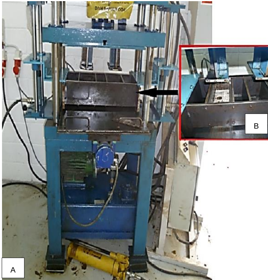
Figura 2 – Prensa hidráulica para confecção de PPCA: (A) Prensa hidráulica; (B) Detalhe formas.
