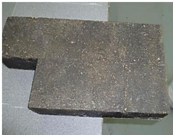
Figura 15 – Interconexões das PPCA com juntas de 0mm
