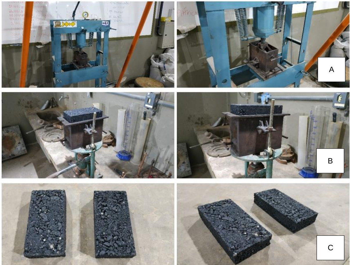
Figura 35 – Equipamentos de moldagem de CP's: (A) Prensa de moldagem por amassamento das PPCA; (B) Macaco extrator das PPCA; (C) PPCA finalizadas.
