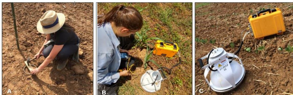
FIGURA 6. Instalação do colar de PVC (A) e avaliação durante o cultivo do milho (B) e feijão (C).
