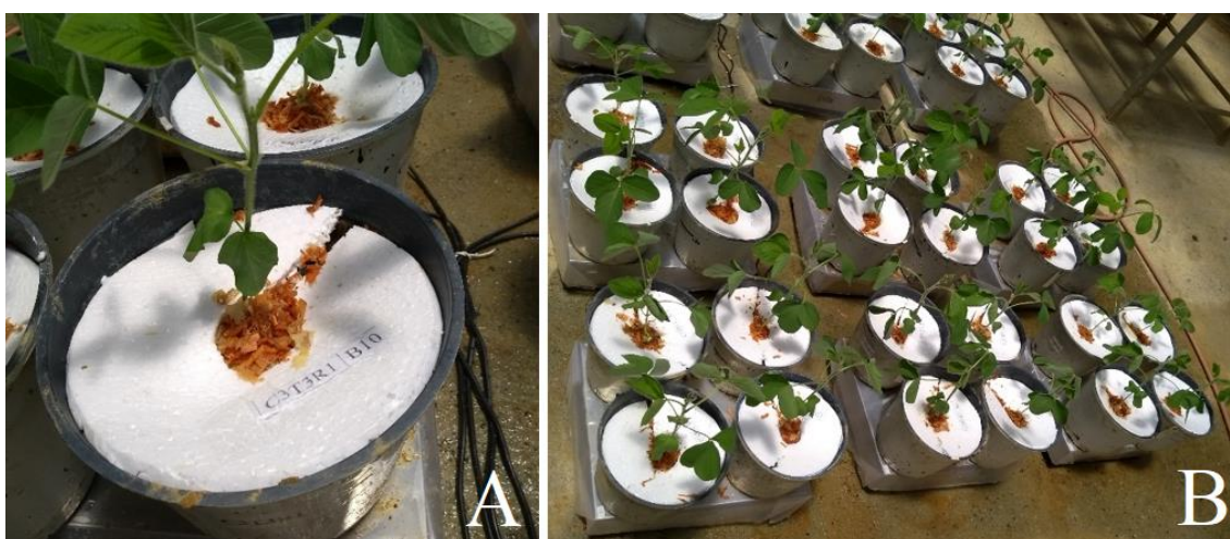
Figura 1. Conjuntos de lisímetros de pesagem. A: vaso de 5L preenchido com solo coberto com serragem e disco de isopor, e planta de soja; B: disposição dos vasos em balanças de precisão.
