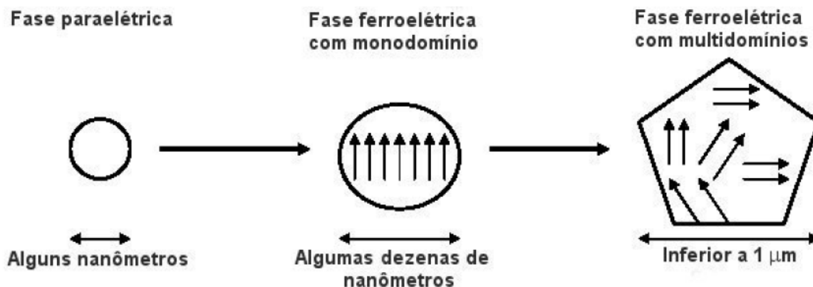
Figura 14 - Descrição esquemática do efeito do tamanho de grão na estrutura de domínio ferroelétrica. Adaptado da referência [43].
