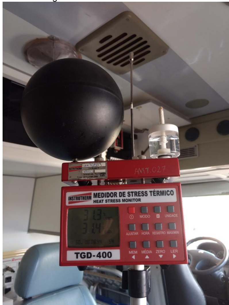
Figura 3. Medidor de Stress Térmico posicionado a altura do tórax do trabalhador no interior do veículo de emergência
