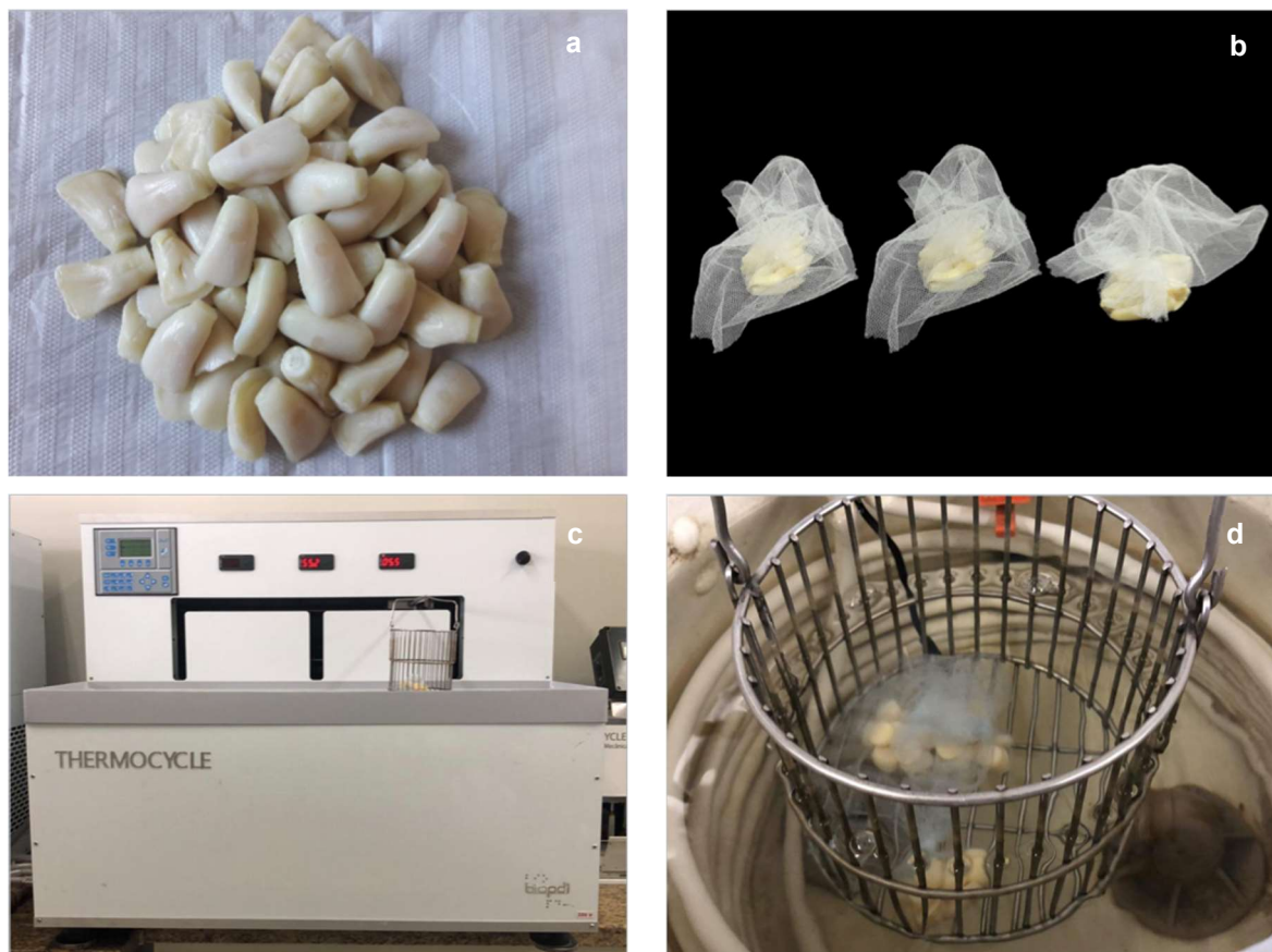
Figura 11: (a, b) Dentes separados para a termociclagem; (c, d) Termociclagem.
