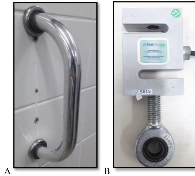
Figura 3. A. Barra de apoio fixada na parede para sustentar o dinamômetro e o elástico. B - Dinamômetro de tração e pressão (EMG System) com olhal acoplado.
