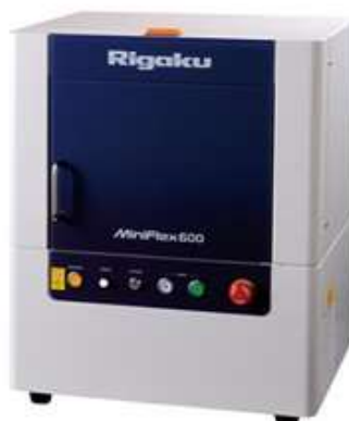
Figura 8 – Foto ilustrativa do difratômetro de raios-X Rigaku Miniflex 600
