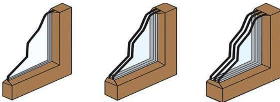
Figura 17: Exemplos de esquadrias com vidros simples, duplos e triplos
