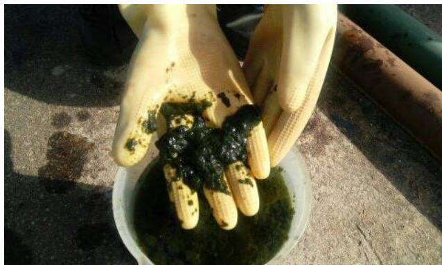
Figura 12 – Biomassa algácea após processo de separação sólido-líquido
