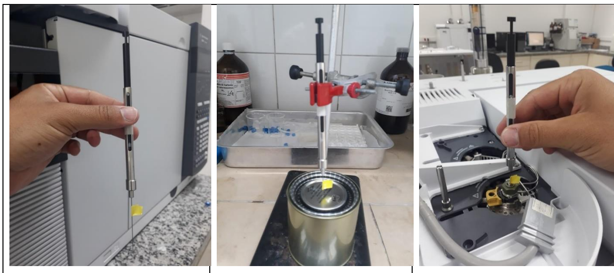
Figura 13. Dispositivo montado para extração dos voláteis oriundos da queima dos materiais, (a) Dispositivo SPME, (b) Exposição da fibra no interior da lata, (c) injeção do SPME no CG-EM.
