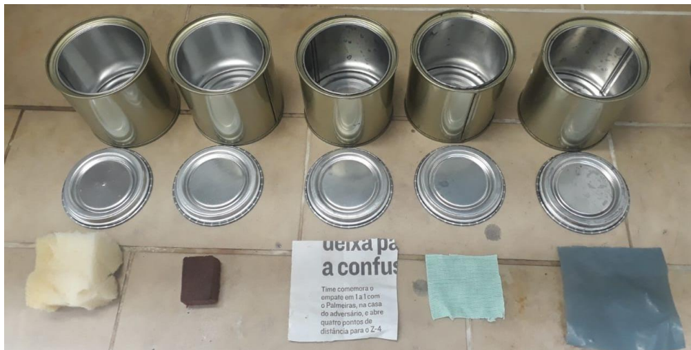
Figura 11. Substratos utilizados nos testes realizados. Da esquerda para a direita: espuma, madeira, papel jornal, tecido e plástico.
