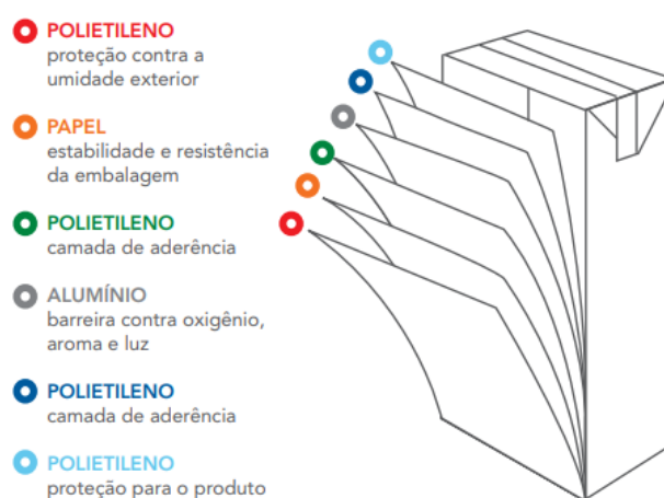
Figura 2.1 - Estrutura de uma embalagem cartonada.
