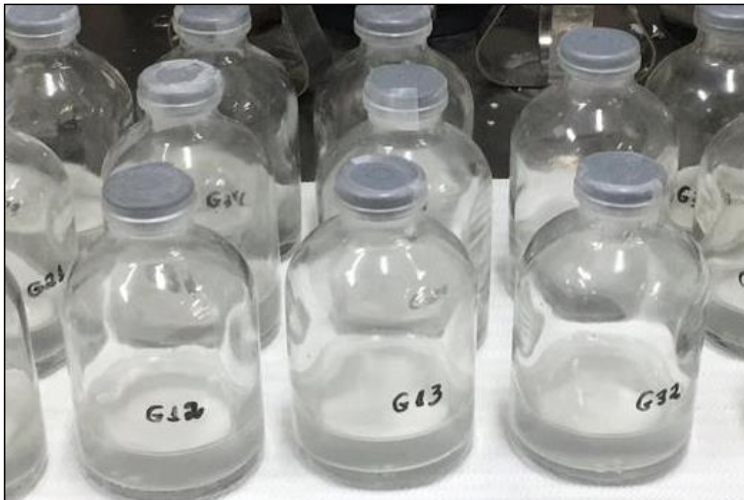
Figura 5 - Teste de fermentação em meio sintético realizado em frascos de 50 mL.
