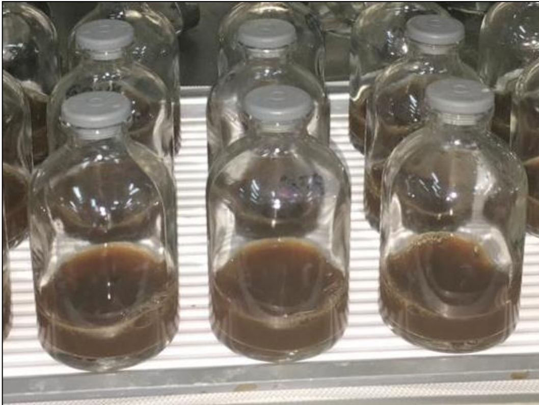
Figura 6 - Teste de fermentação do hidrolisado realizado em frascos de 50 mL.
