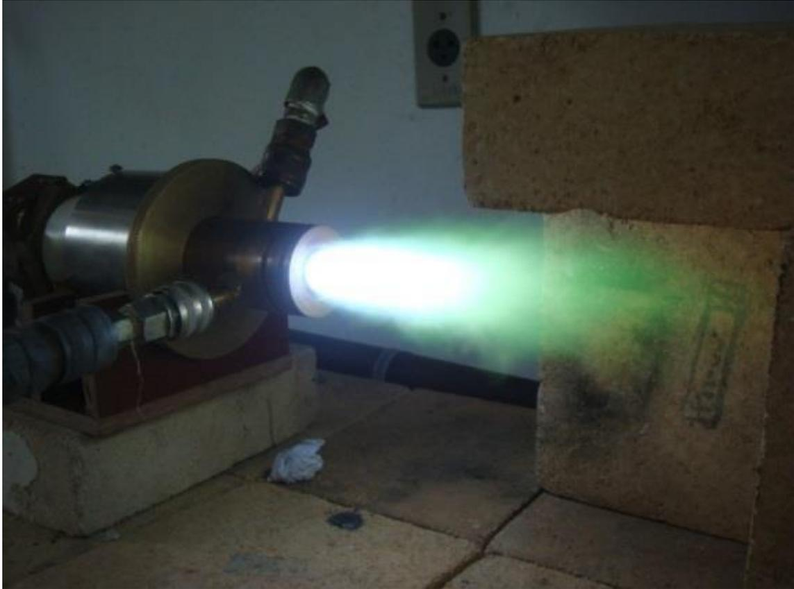
Figura 8 – Tocha de plasma térmico com cátodo de zircônio, ânodo reto, arco não-transferido operando com CO<sub>2</sub>, desenvolvida no LPT, UFES.
