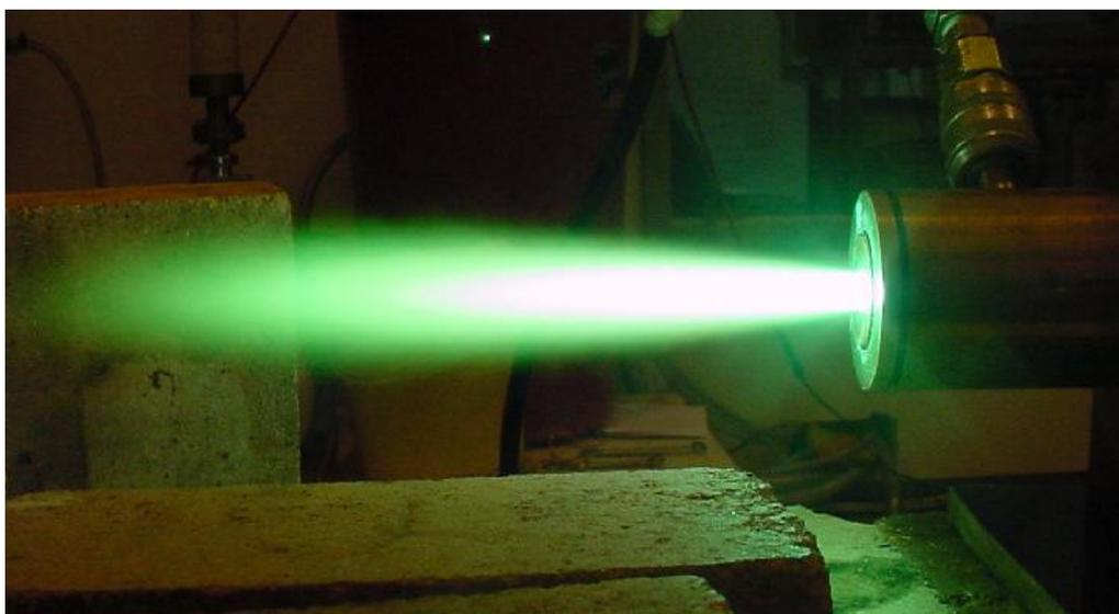
Figura 5 – Tocha de plasma térmico com potência de 80 kW operando com arco não-transferido confinado por parede fria, desenvolvida no LPT, UFES.
