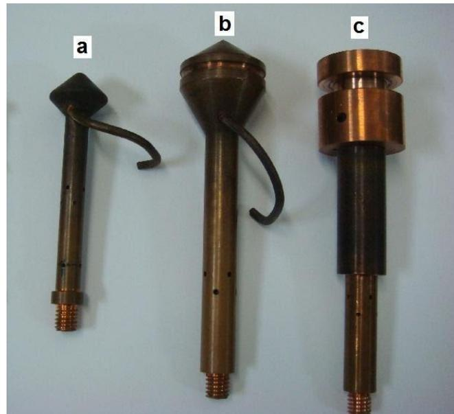
Figura 24 – Imagens dos cátodos testados no desenvolvimento do MGA ao MGA-CCE: a) Protótipo 1: cátodo com uma superfície com duplo cone; b) Protótipo 2: cátodo com um entalhe relativamente pequeno em forma de U; c) Protótipo 3: cátodo com um entalhe retangular relativamente profundo. Na foto o cátodo está sem a espiral para a ignição inicial.
