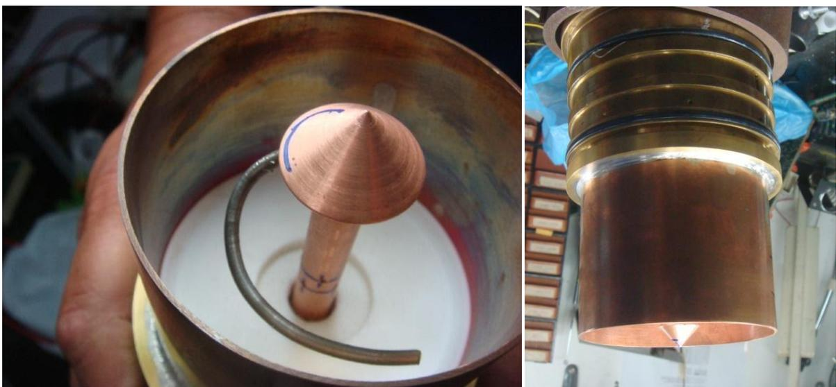
Figura 25 – Protótipo 1 em um MGA onde o ânodo tem diâmetro interno de 77 mm.
