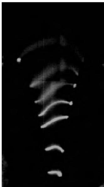
Figura 13 – Deslocamento do arco deslizante do regime térmico para não térmico; usando uma sequência de exposições de fotos (FRIDMAN, A', 2008).
