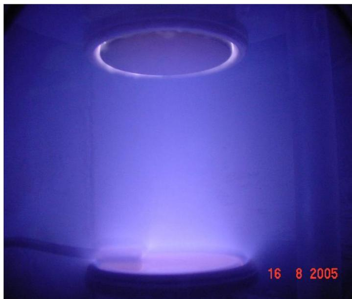
Figura 4 – Descarga *glow* em um reator a baixa pressão, desenvolvido no LPT (Laboratório de Plasma Térmico), UFES.
