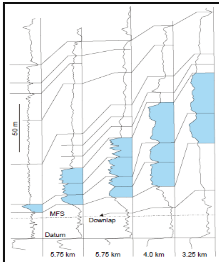
Figura 8: Correlação de poços como técnica para identificação de superfícies. (CATUNEANU, 2006)
