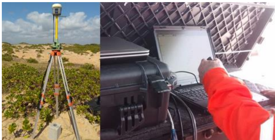
Figura 9 - Instrumentos utilizados no levantamento topobatimétrico. Base de GPS RTK instalada sobre marco geodésico para levantamento topográfico (à esquerda) e computador utilizado a bordo para coleta de dados batimétricos (à direita).
