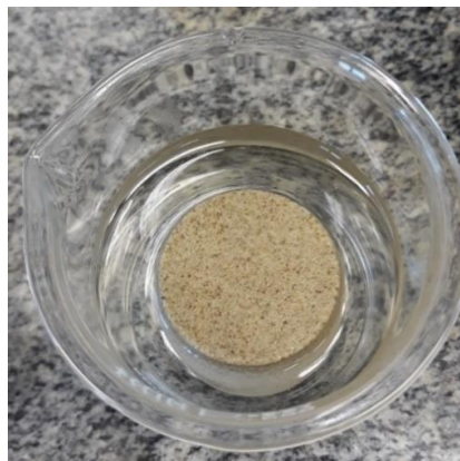
Figura 20. Testemunho rochoso no béquer com solução de saturação. Fonte: Autor
