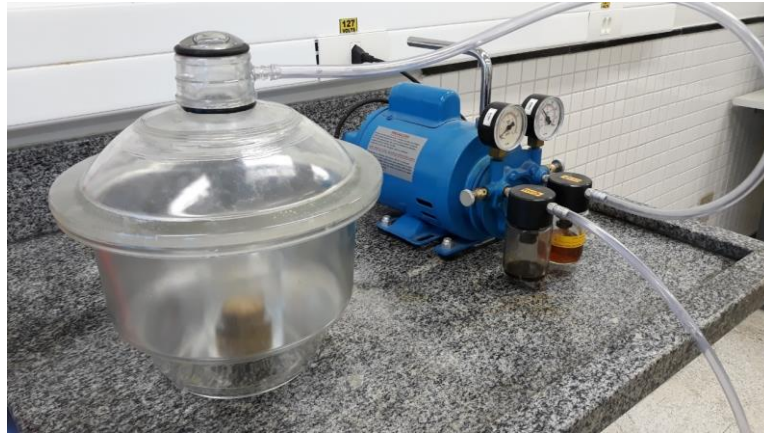
Figura 21. Testemunho rochoso no dessecador para saturação com solução de KCl. Fonte: Autor
