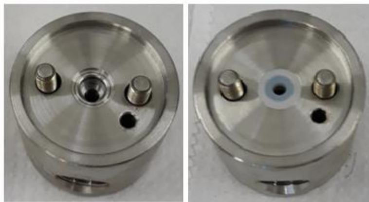
Figura G08 - Cabeçote da bomba sem selo (esquerda) e com o selo posicionado (direita). Fonte: Autor.
