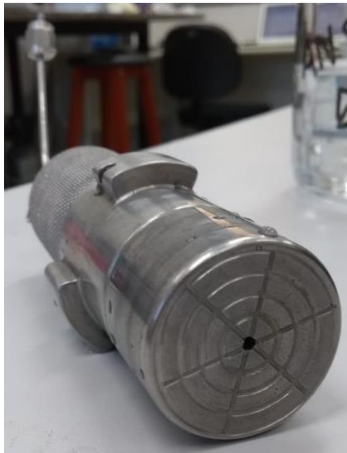
Figura 15. Detalhe dos canais de distribuição na tampa de entrada do core holder . Fonte: Autor.
