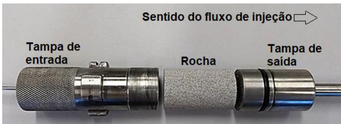
Figura 16. Tampas laterais do core holder posicionadas junto ao testemunho. Fonte: Autor.
