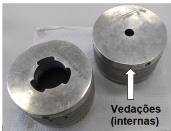
Figura G14 - Tampas roscadas com indicação da posição das vedações. Fonte: Autor.
