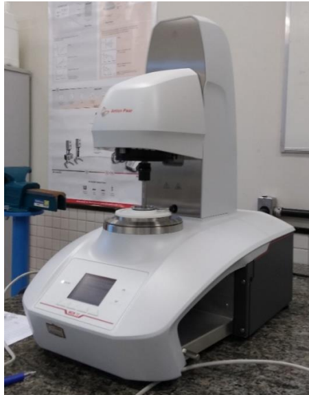
Figura 18. Reômetro Anton Paar MCR72 do laboratório de Petróleo e Gás do PPGEN. Dimensões: 54 cm x 34 cm x 65 cm. Fonte: Autor.
