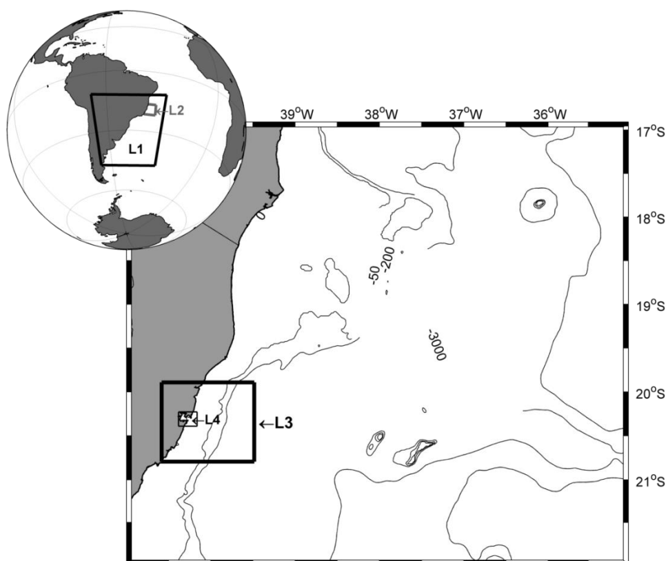
Figura 7: Sistema de grades aninhadas da modelagem hidrodinâmica (L1, L2, L3 e L4 – SEIV). Fonte: Curbani (2016) e Lacerda (2016).
