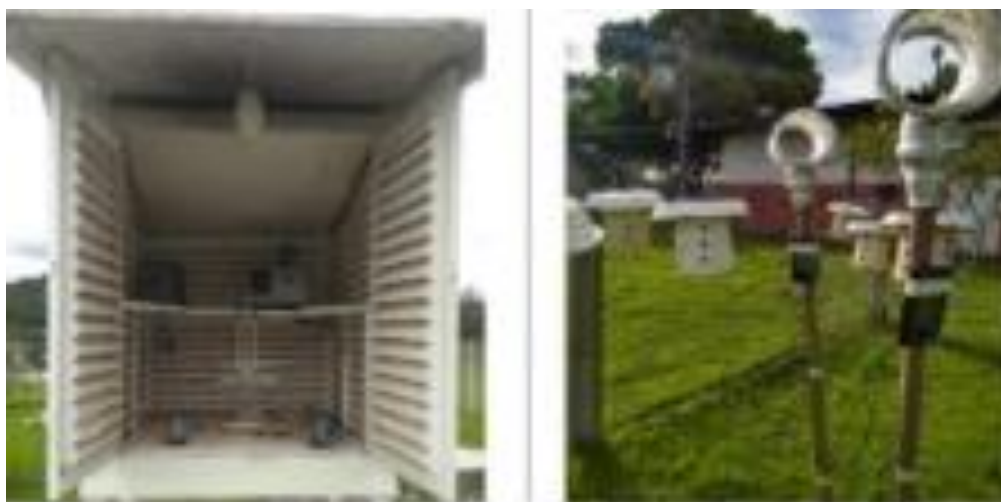
Figura 17: Aferição em campo dos termohigrômetros modelo Minipa na estação automática do INMET instalada no campus da UFES.
