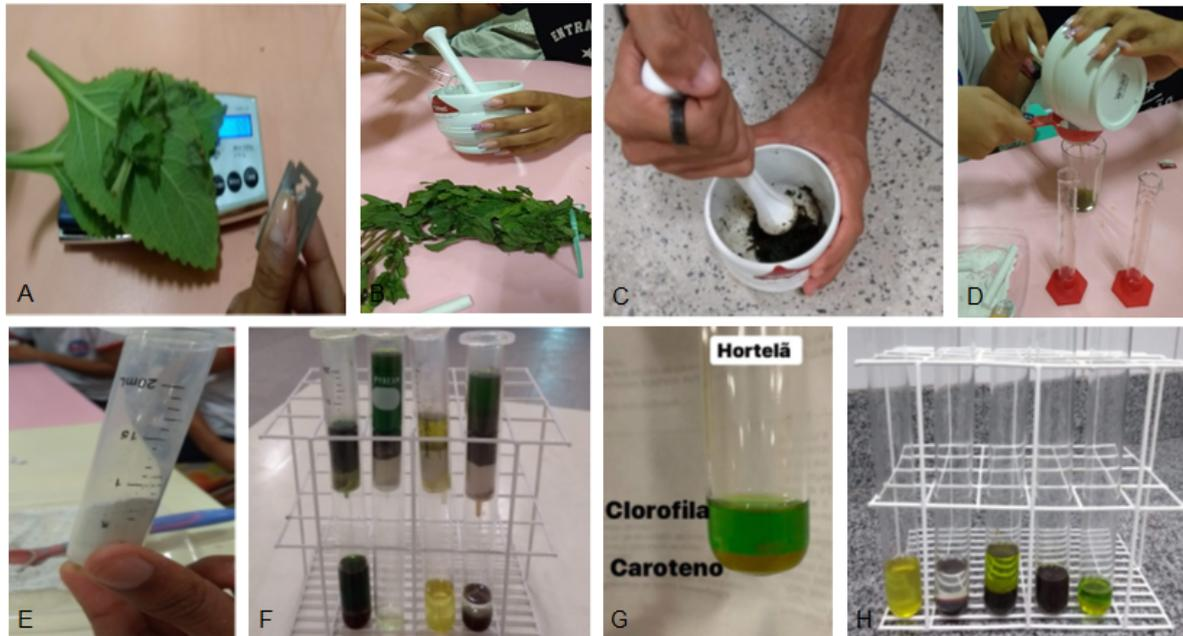
**Figura 5** - Experimento da cromatografia em colunas. A: pesagem da amostral; B: preparação da fase móvel - eluente; C: maceração da amostra com o eluente; D: coando o extrato; E: preparação da coluna – fase fixa; F: separando os pigmentos; G: visualizando os pigmentos; H: pigmentos extraídos de várias amostras – erva doce, hibisco, boldo, algodão e hortelã.
