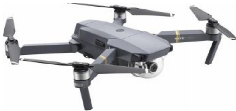
Figura 5. Quadricóptero da DJI Mavic Pro usado no projeto.
