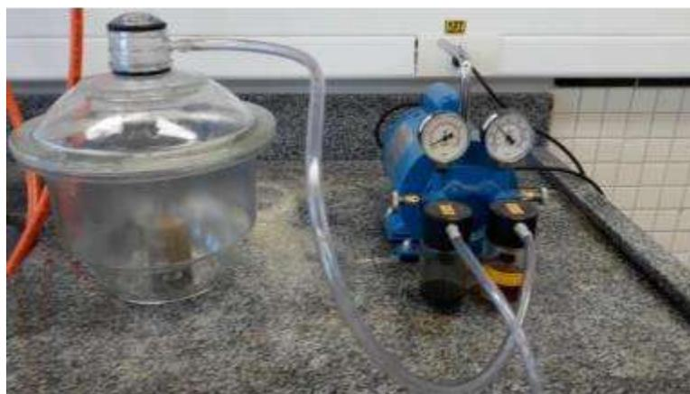
Figura 26- Representação experimental do processo de saturação. Fonte: o autor.
