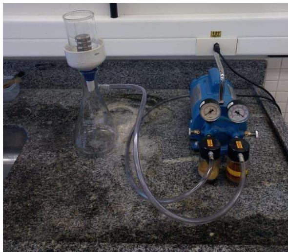
Figura 28 - Representação experimental do procedimento de limpeza do meio poroso. Fonte: o autor.
