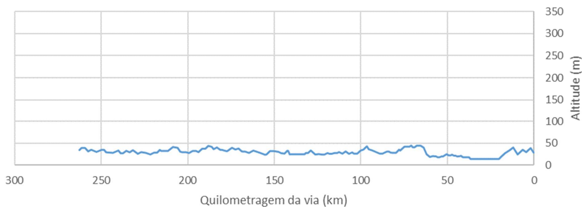
Gráfico 5.25 – Perfil altimétrico do trecho da EFC de Alto Alegre até o Porto de Ponta da Madeira
