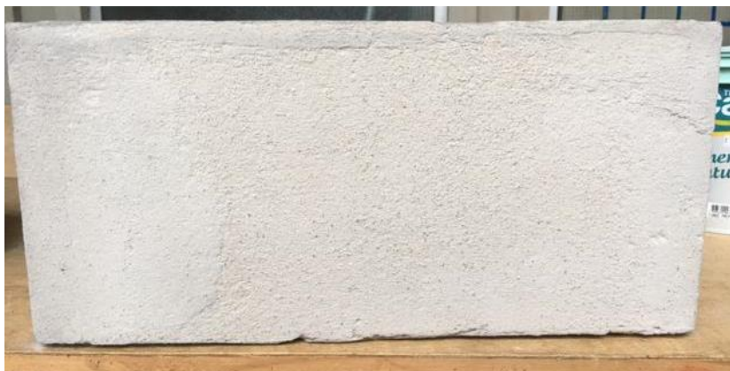
Figura 14 – Bloco rebocado após período de cura
