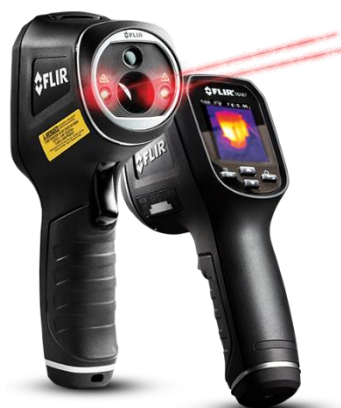
Figura 19 – Câmera termográfica utilizada nas medições
