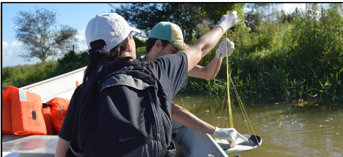
Figura 62 - Aferição da visibilidade com o disco de Secchi, ponto 1, 2017.
