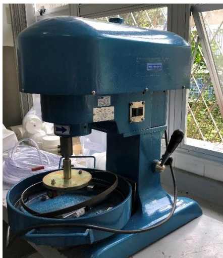
Figura 39 - Equipamento de desgaste WTAT
