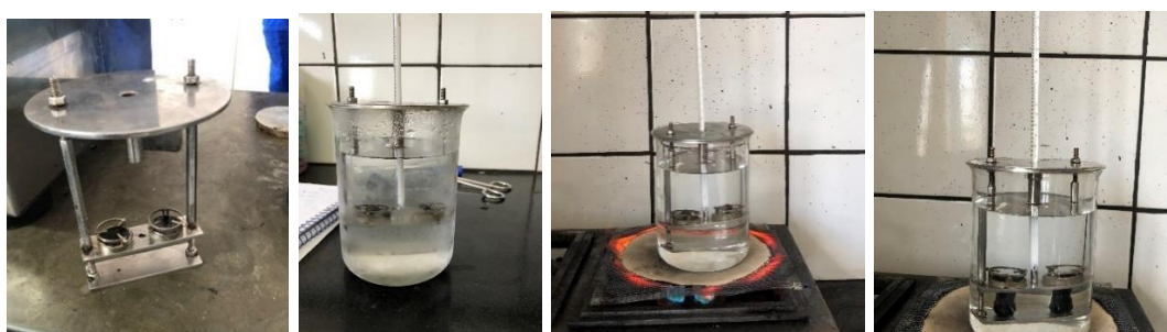
Figura 32 - Ensaio de ponto de amolecimento
