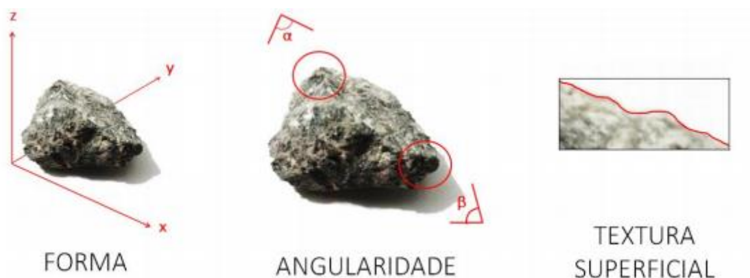
Figura 23 - Forma, angularidade e textura superficial dos agregados
