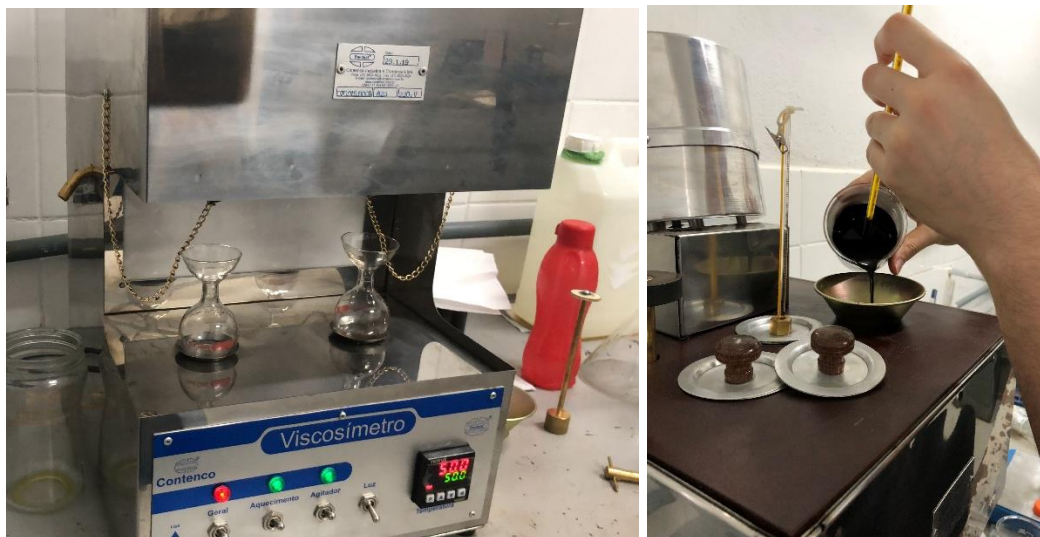
Figura 29 - Ensaio de Viscosidade Saybolt Furol
