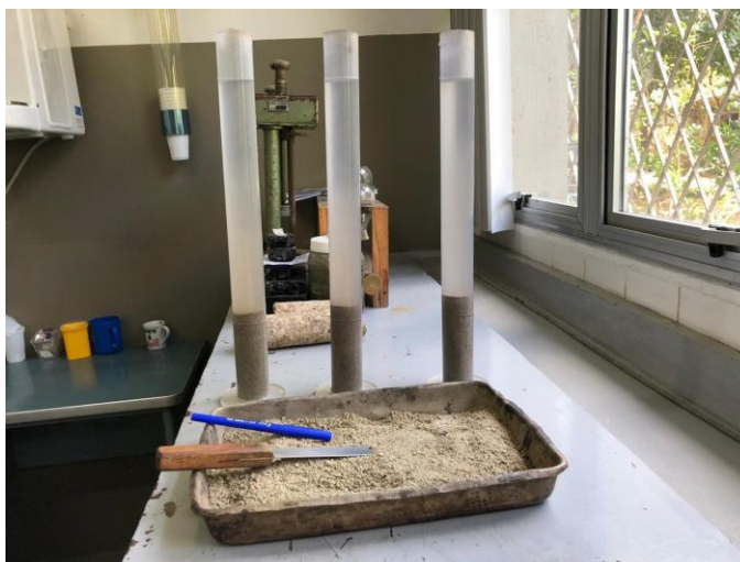
Figura 27 - Ensaio Equivalente de areia
