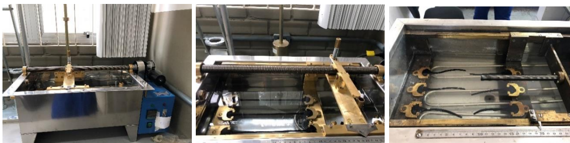
Figura 33 - Ensaio de recuperação elástica no ductilômetro
