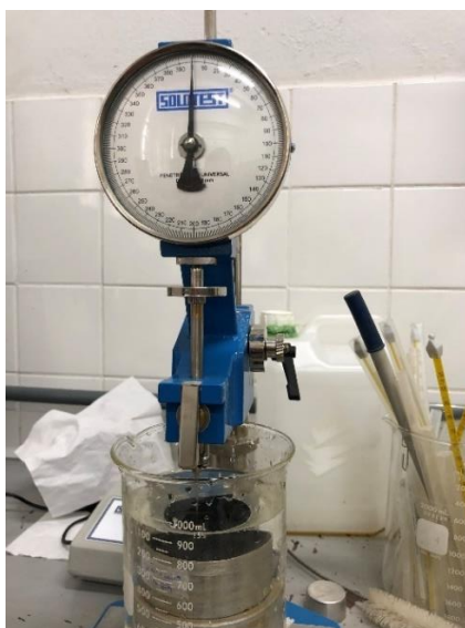
Figura 31 - Aparelho para determinação da penetração do resíduo da emulsão
