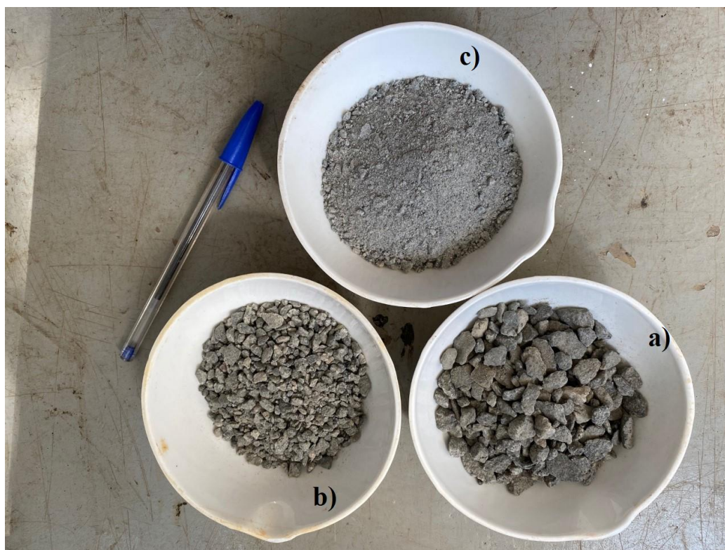
Figura 19 - Agregados naturais a) Brita 0 b) Granilha c) Pó de brita
