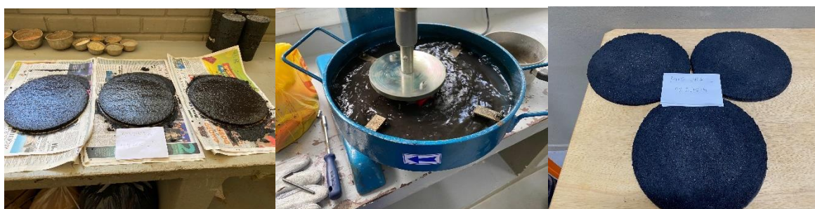
Figura 40 - Ensaio de resistência a abrasão úmida - WTAT
