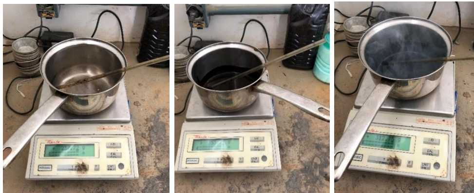
Figura 30 - Ensaio pelo método expedito - Resíduo seco por evaporação
