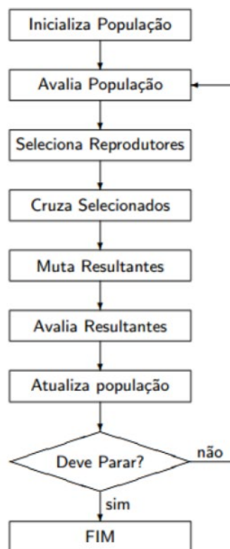
Figura 5.2 – Fluxograma com as etapas de otimização por Algoritmo Genético
