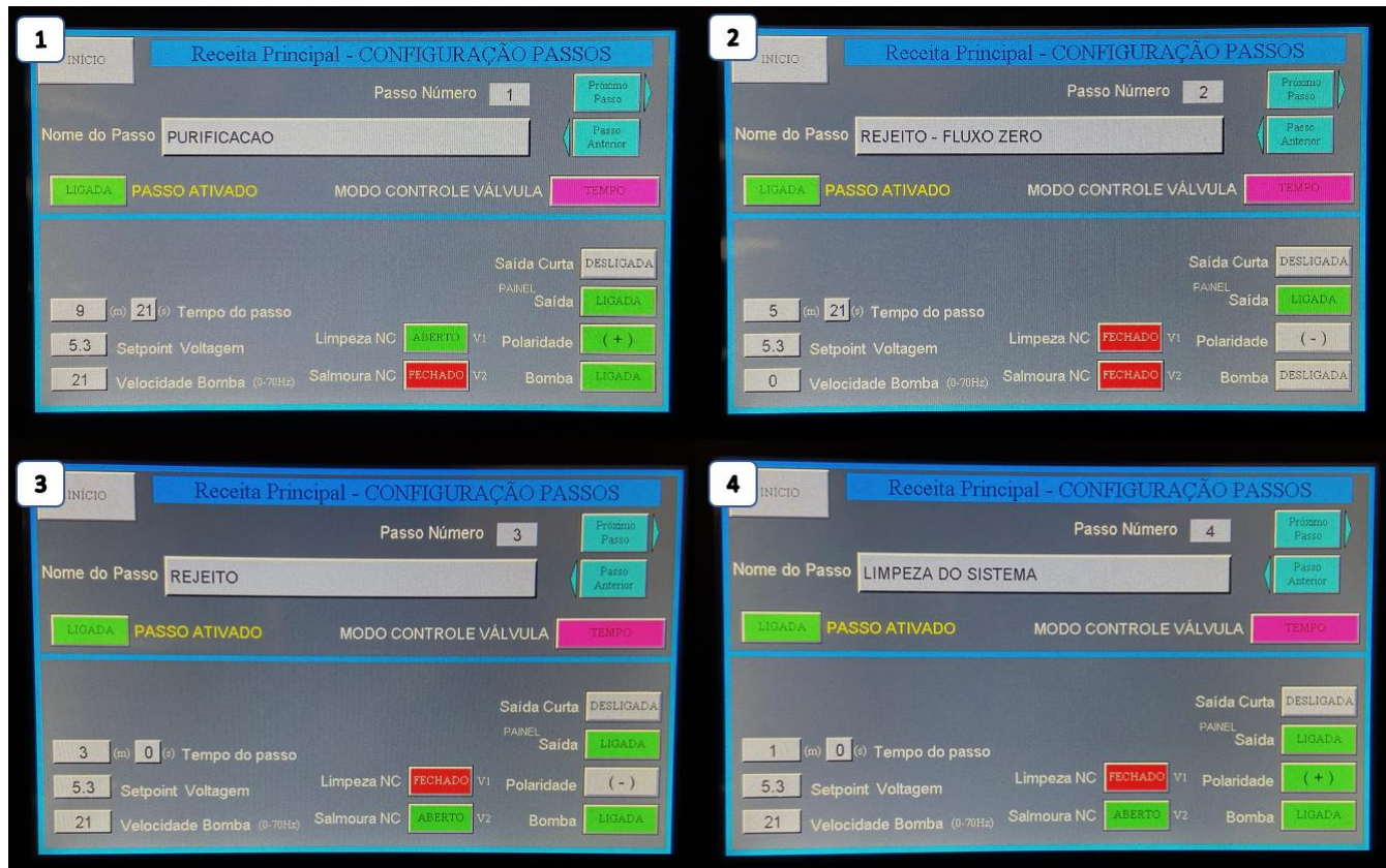
Figura 23 - Configurações das etapas do ciclo de tratamento
