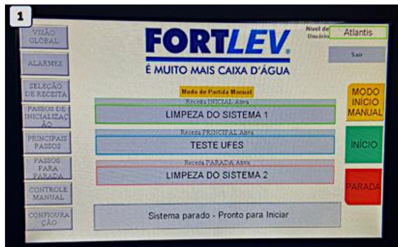
Figura 13 - Tela inicial da Interface homem máquina (IHM) do RDI S-10
