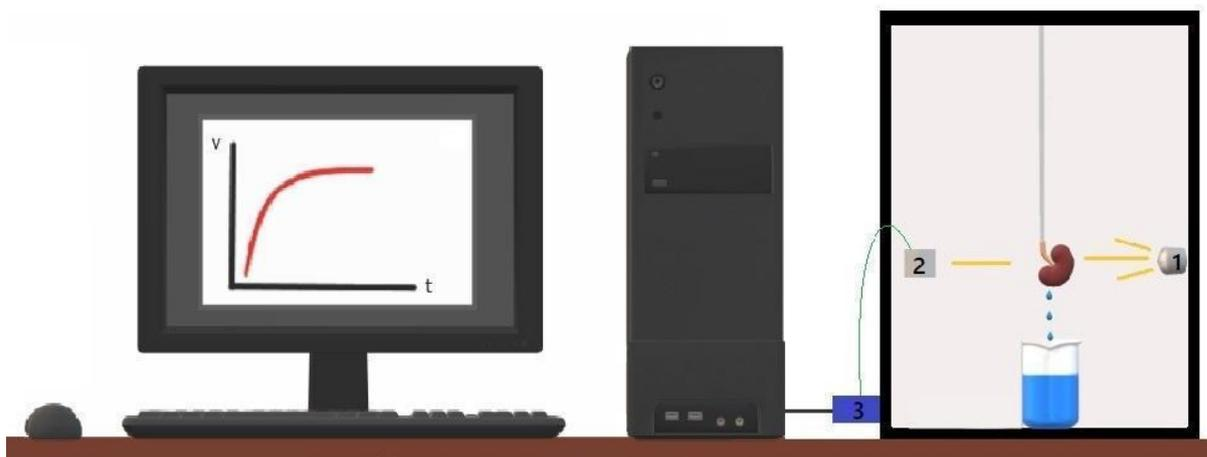
**Figura 8.** O sistema de sensoriamento óptico. A fonte luminosa de LED (1) posicionada diametralmente ao Fotodiodo (2). A Placa de prototipagem (3) está localizada no lado direito externo da câmara do Sensor e está conectada a um computador por uma porta USB. Fonte: próprio autor.
