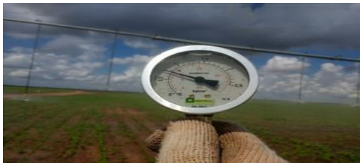
Figura 22 - Exemplo de manômetro metálico, para pivôs centrais.
