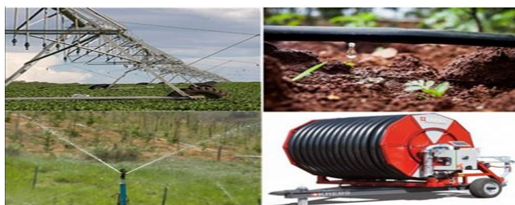
Figura 64- a) Pivôs de Irrigação Krebs Aspersion Convencional bicos spray, b) irrigação por gotejamento, c) Irrigação por aspersion e d) Carretel Krebs 125.
