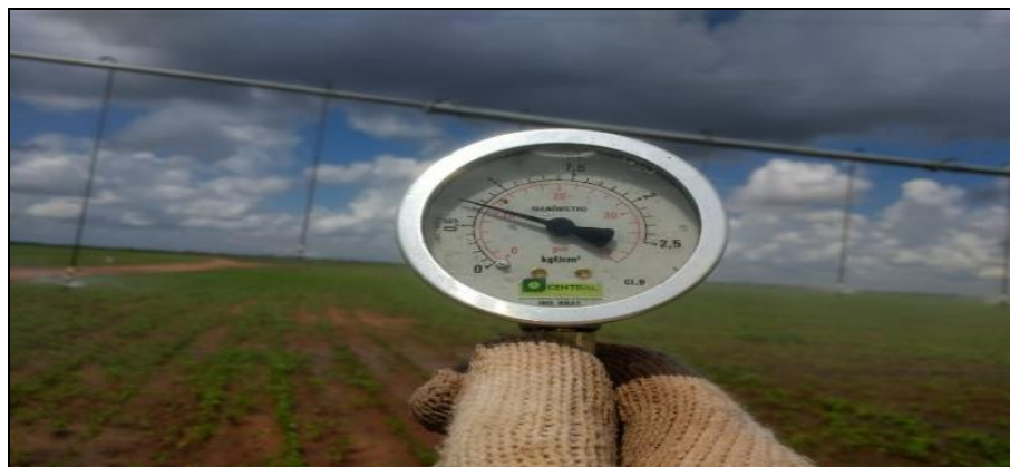
Figura 61 -Exemplo de manômetro metálico, para pivôs centrais.
