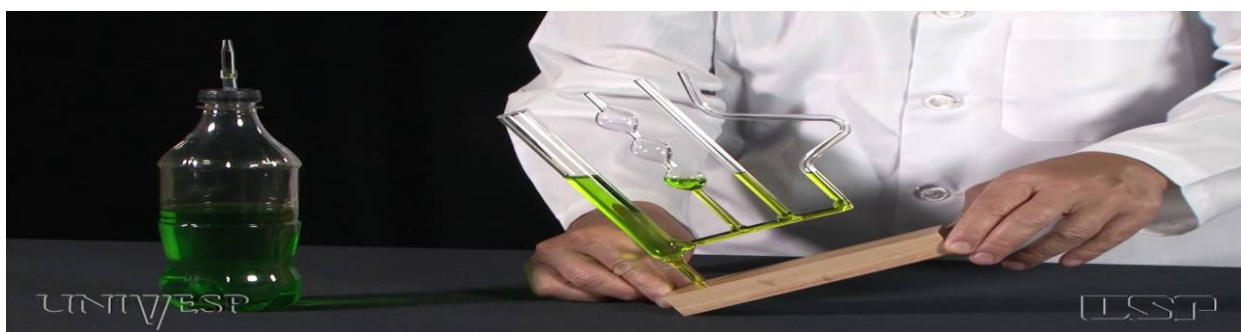
Figura 43 – Podemos visualizar, mesmo em inclinação, a pressão que a água exerce sobre uma superfície, não depende do volume de água, e relacionar a altura do nível da água.
