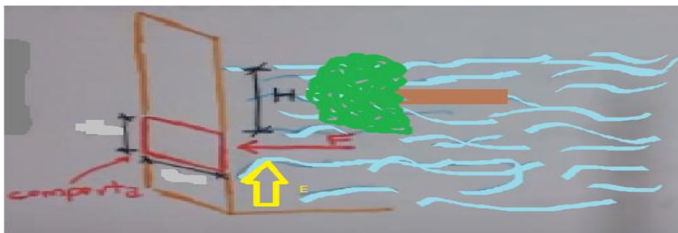
Figura 18 - Ilustração das forças atuantes no barramento da água.
