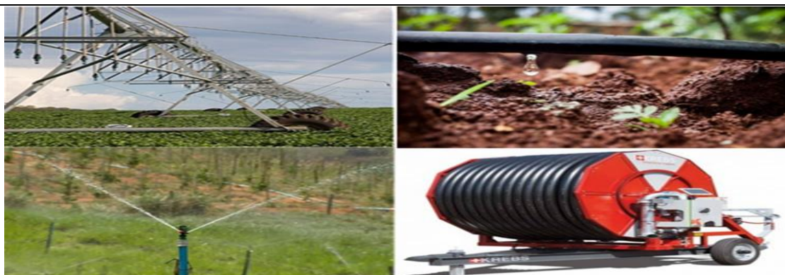
Figura 25 - a) Pivôs de Irrigação Krebs Aspersor Convencional bicos spray, b) irrigação por gotejamento, c) Irrigação por aspersão e d) Carretel Krebs 125.
