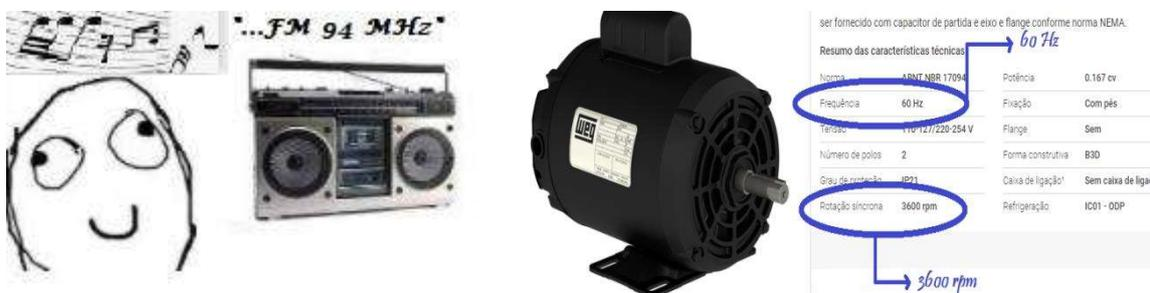
Repare que a frequência de sintonia da rádio FM é 94 MHz (megahertz), isto é, 94 milhões de ciclos por segundo, um número quase impensável de ciclos. Já a frequência da rede elétrica é 60 Hz (60 oscilações por segundo), enquanto o motor completa 3600 rotações a cada 1 minuto
