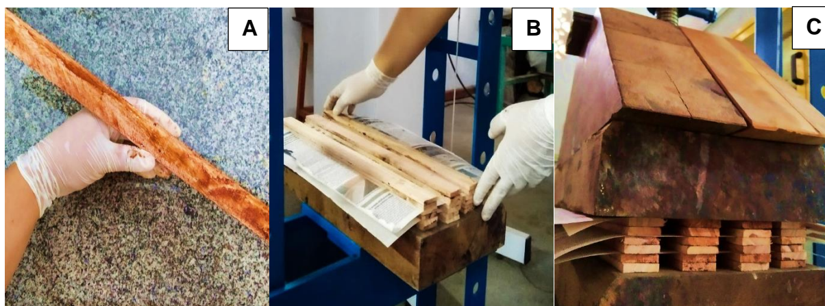
A – Aplicação do adesivo e montagem das lamelas coladas; B – Colocação das taliscas coladas na prensa; C – Prensagem das juntas coladas.
