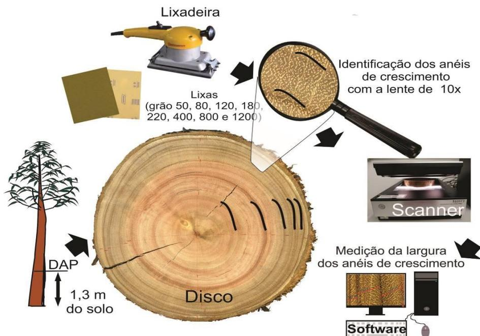
Figura 2. Esquema das etapas de preparo dos disco do DAP para a medição das larguras de anéis de crescimento em dois clones de eucalipto em 5 sítios no Brasil.
