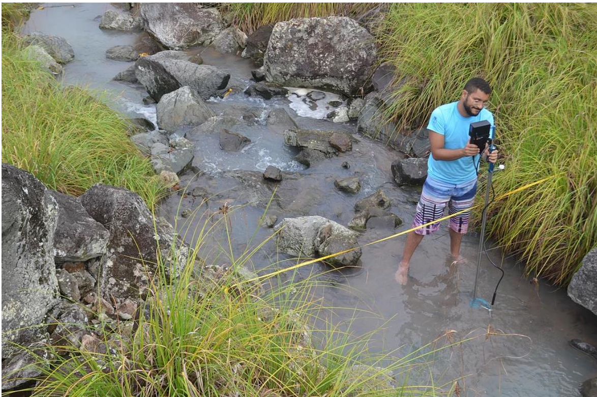
Figura 23 - Medição da vazão no Córrego de Captação com uso de Flowtaracker® em março de 2019.
