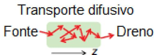
**Figura 37:** Esquema do transporte difusivo em um condutor.
