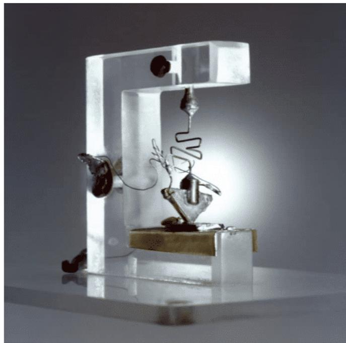
**Figura 1:** Réplica do primeiro transistor apresentado em 1947 na Bell Laboratories
