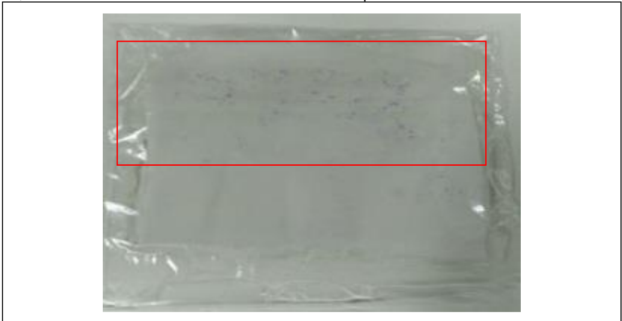
Figura 59 - Membrana PVDF após incubação com antiCB1 conjugado com Composto 2, sendo evidenciado o excesso de fluoróforo no quadro vermelho
