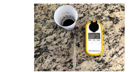
Figura 3- Refratômetro digital utilizado para a análise de sólidos solúveis totais dos 288 genótipos de *E. edulis* coletados em Rio Novo- ES
