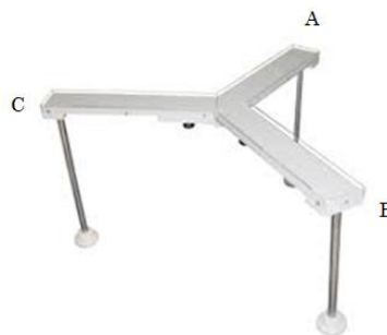
Figura 13: Labirinto em Y. Equipamento comumente utilizado na avaliação da memória operacional, através da alternância espontânea do animal.
