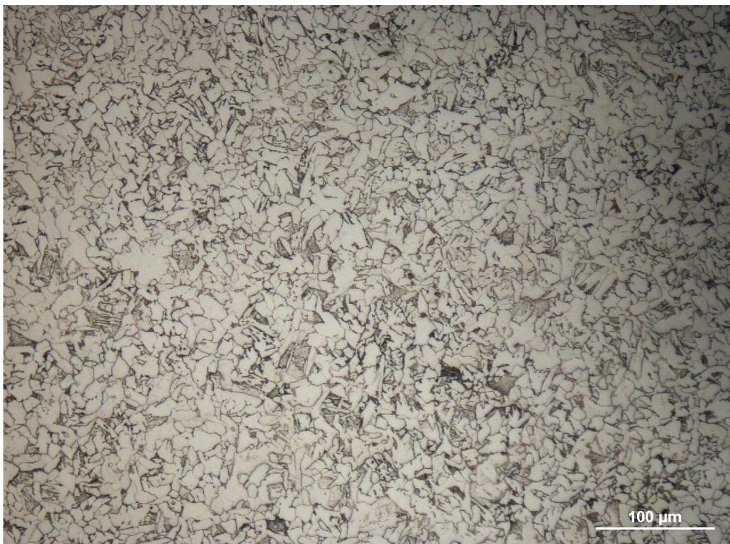
Figura 7.1: Microestrutura do aço AISI 1020 com aumento de 200X. Atacado com Nital 2% por 25s. Fonte: AUTOR.
